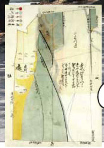
嘉永5年(1852左)/安政2年(1855右)の絵図 いずれも上流で決壊し、堤防の裏側を流れてきた洪水流が「もようげん堤」が跳ね返している。
