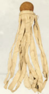
梵天 (ぼんてん) 下に竹棒を付け、測量の目印とした
