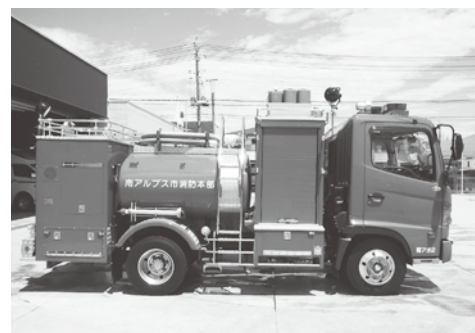
現在、八田消防署で使用している 小型動力ポンプ付水槽車
